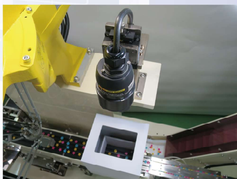
2種類の形状の部品を1台の パーツフィーダで選別、振分、整列
