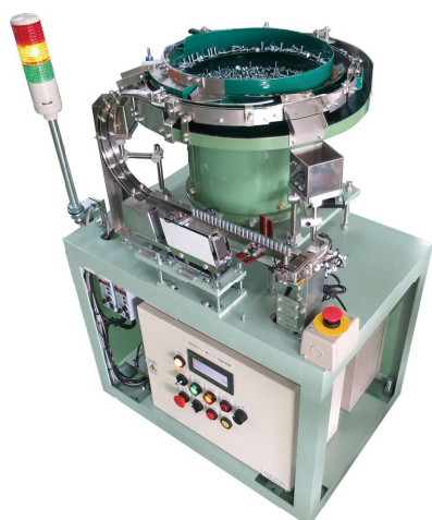
ワーク：M14×35Lボルトとスプリングワッシャの2点仮組み 能力：25個／分
